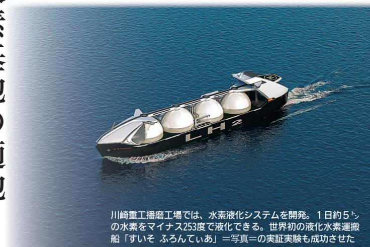
川崎重工播磨工場では、水素液化システムを開発。1日約5トンの水素をマイナス253度で液化できる。世界初の液化水素運搬船「すいそ ふろんていあ」＝写真一の実証実験も成功させた
